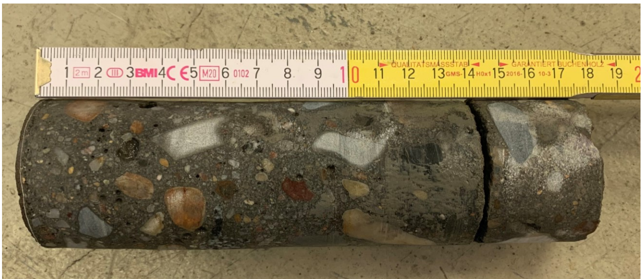
Bohrkern Bodenplatte Bereich zwischen den Stützen
